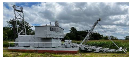
▲泥炭浚渫船(でいたんしゅんせつせん) かつて土壌改良材として利用されていた「泥炭」を、湿原から採掘するために使用されていた船。湿原の木道付近で観光客を出迎える。
